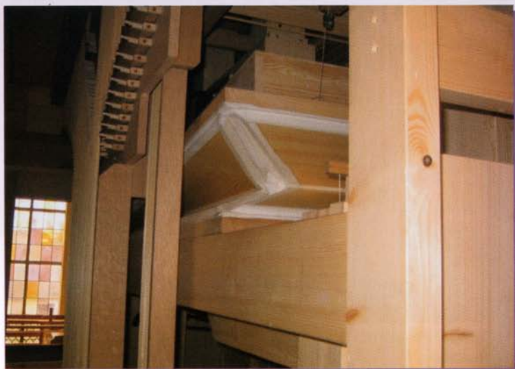
Tonmechanik und Blasbalg des Schwellwerks
