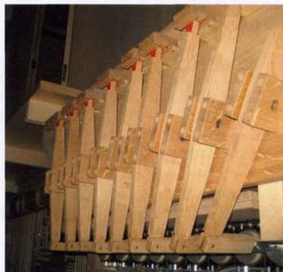
Wippen an der Hauptwerkswindlade, darunter Registerzugmagnete
