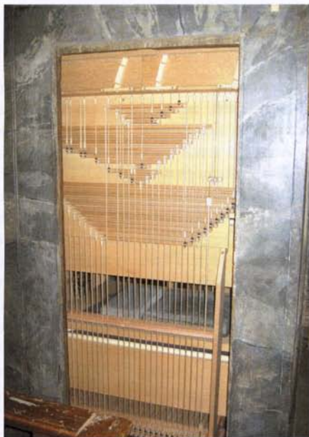
Wippen an der Hauptwerkswindlade, darunter Registerzugmagnete
